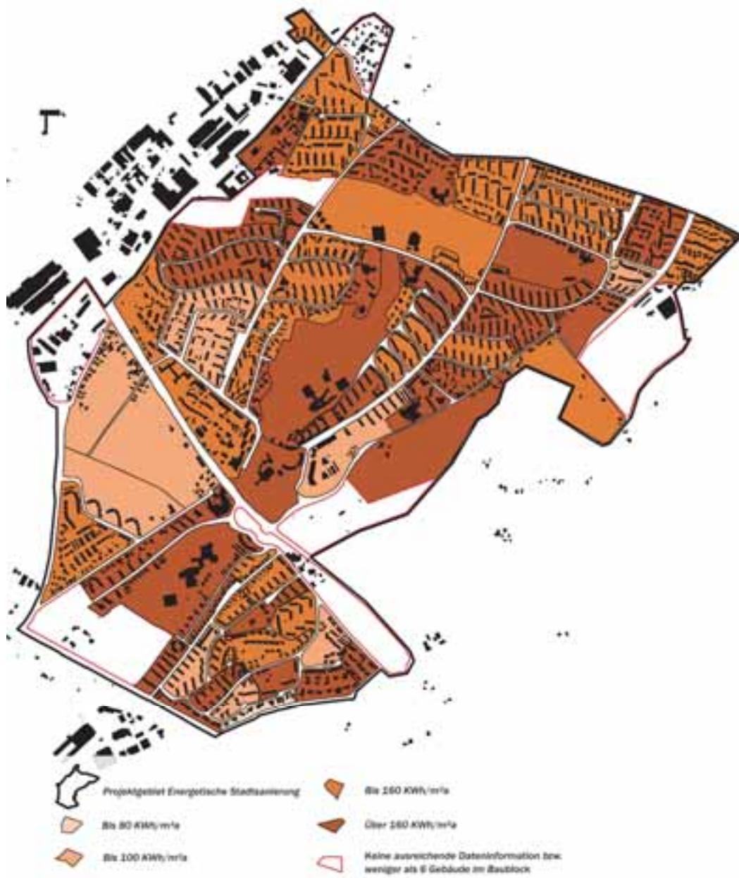
Abbildung 13: Spezifischer Wärmebedarf in den Baublöcken
