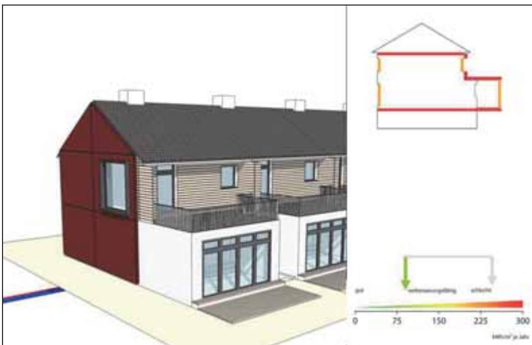
Abbildung 43: KfW 115-Standard durch Überformung von Gartenfassade und Giebel
